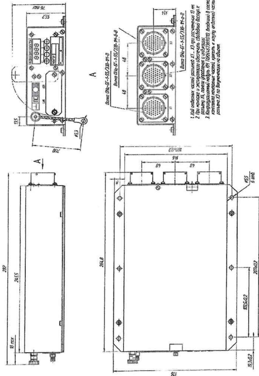
Рис. 1 Габаритный чертеж УБС-К
