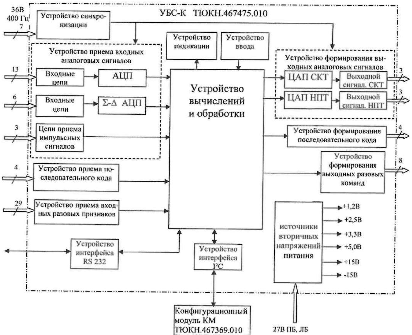
Рис.1 Функциональная схема УБС-К
