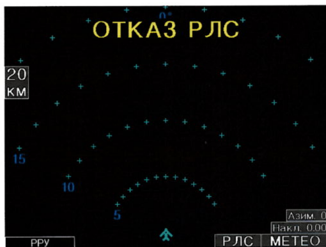
Рисунок 101 – Изображение на экране СЭИ при отказе изделия в режиме «Метео»
