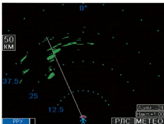
Рис. 25 – Пример 6: Вид в азимутальной плоскости, масштаб 50 км, режим «Метео»
