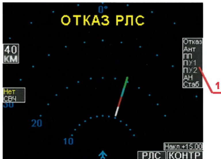
Рисунок 102 – Контрольное изображение на экране МФИ при отказе изделия и каналов входной информации в режиме «Контроль»
