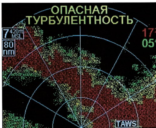
Рисунок 12 – Предупреждение от изделия, работающего в дежурном режиме, об обнаружении опасной турбулентности (на экране СЭИ отображается информация от TAWS)
