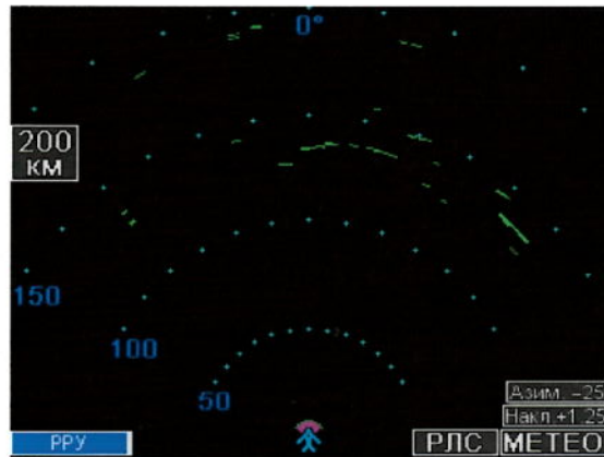
Рис. 22 – Пример 5: Вид в азимутальной плоскости, масштаб 200 км, режим «Метео»
