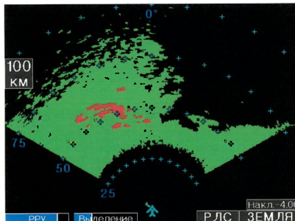
Рисунок 9 – Изображение на индикаторе МНРЛС в режиме «Земля»: видны характерная береговая черта и наземные объекты, масштаб 100 км
