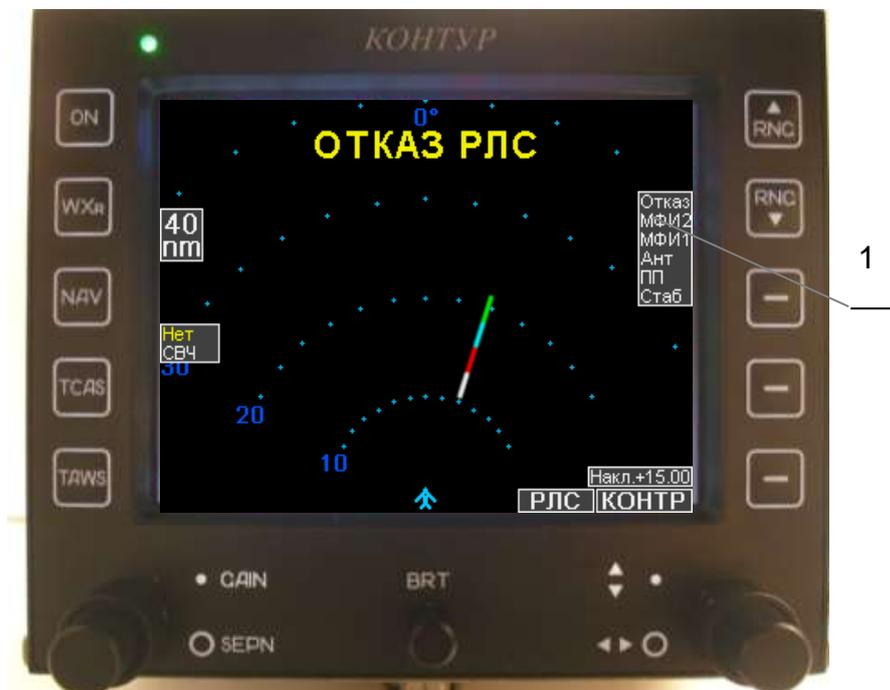
Рисунок 103 - Контрольное изображение на экране МФИ при отказе блоков в режиме «Контроль».
