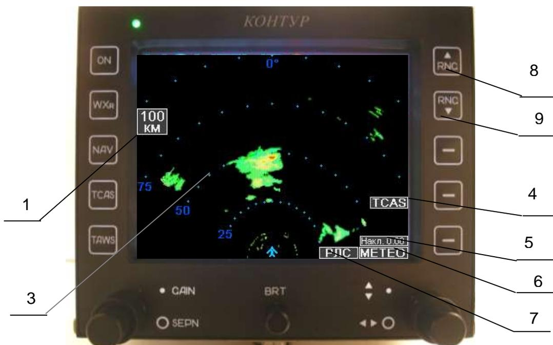
Рисунок 7 - Изображение на экране МФИ в режиме «Метео»
