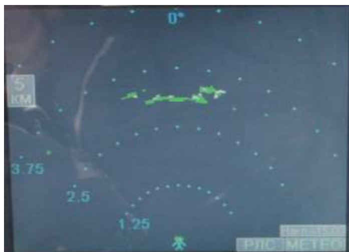
Рисунок 36 – «Кольцо высоты» (высота полета 3 км, наклон +15°, режим METEO)
