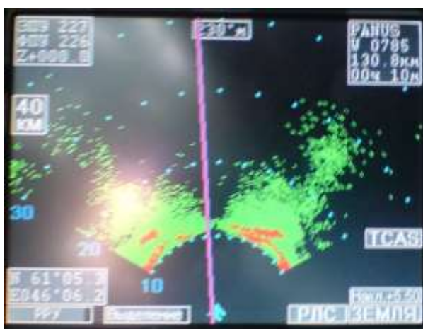
Рисунок 38 – Аномалия «кошачьи глаза» (высота полета 10 км, режим ЗЕМЛЯ, наклон антенны +5,5°)
