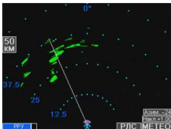
Рисунок 31 – Пример 6: Вид в азимутальной плоскости, масштаб 50 км, режим МЕТЕО
