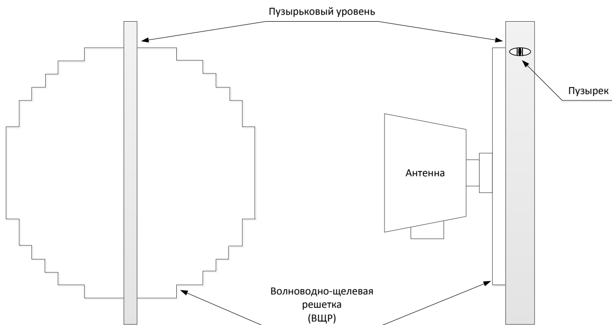
Рисунок 15 – Пузырьковый уровень, закрепленный на волноводно-щелевой решетке (ВЦР) антенны
