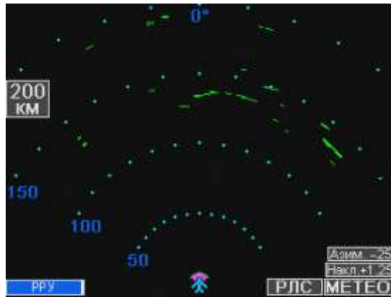
Рисунок 28 – Пример 5: Вид в азимутальной плоскости, масштаб 200 км, режим МЕТЕО
