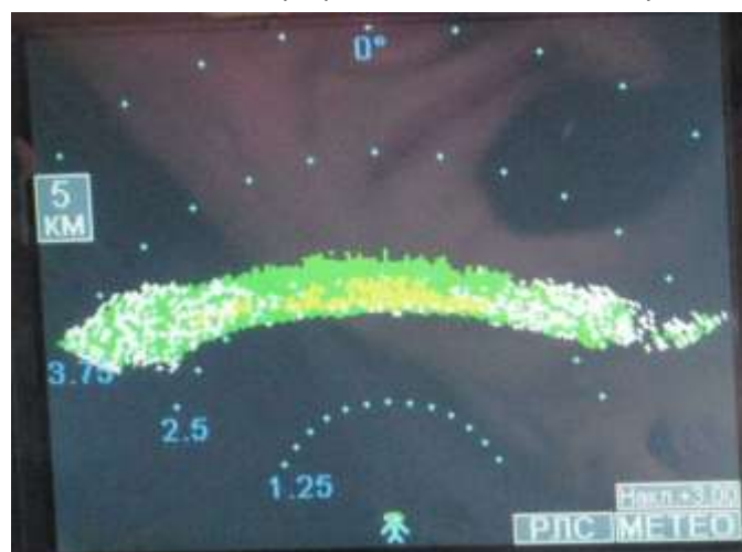
Рисунок 35 – «Кольцо высоты» (высота полета 3 км, наклон +3^\circ , режим МЕТЕО)
